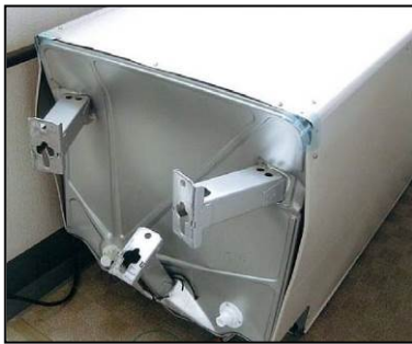
(a) 東日本大震災での様子(転倒後、脚が曲がった一例)
